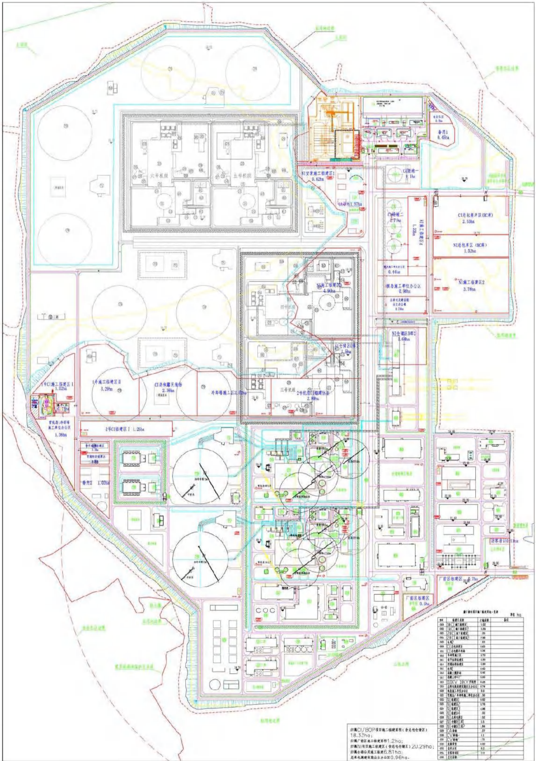
图5.1-1 本项目一期工程施工临建布置图
