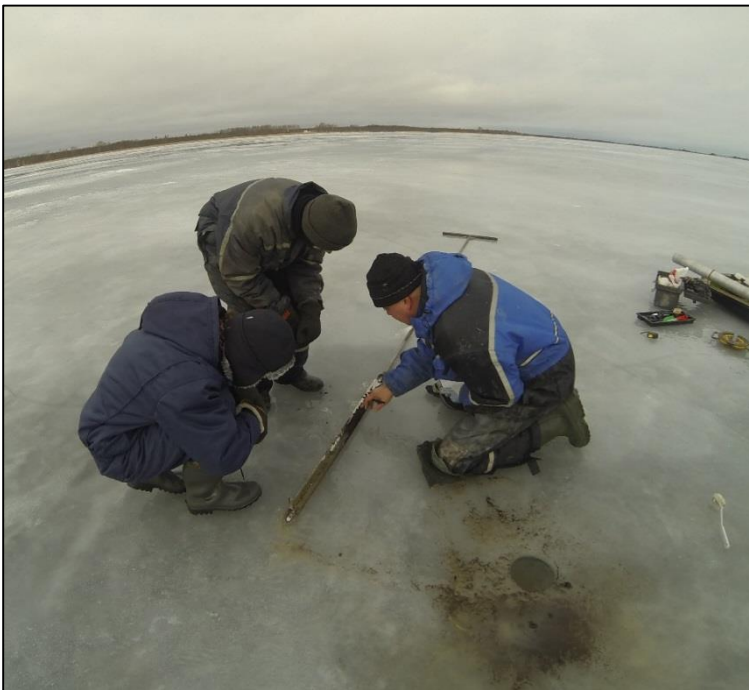
Joonis 11. Puurimine Lämmijärve jääl. Kasutati 1 m pikkust ja raudvarrastega opereeritavat käsipuuri.
