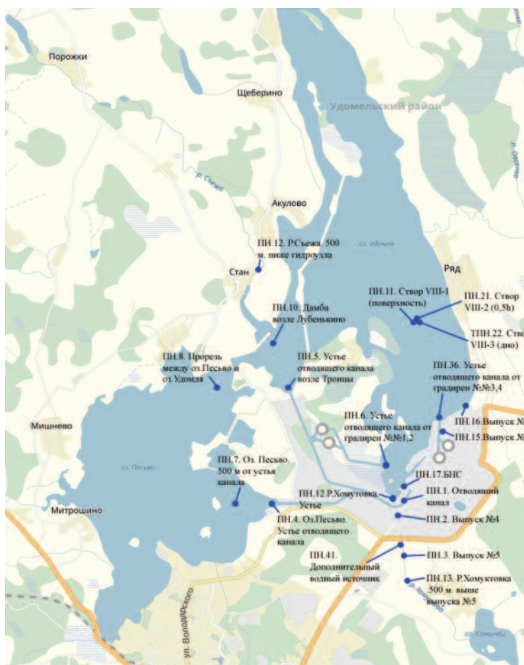
Рис. 5.4. Схема контроля гидрохимических показателей на водоеме охладителя (Водохранилище Калининской АЭС) в зоне наблюдения АЭС.
