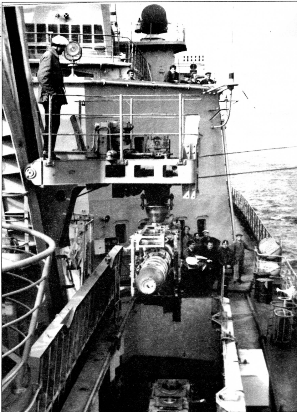
Подача торпеды из хранилища под устройство «Струна» для передачи ее на ТАКР «Минск»
