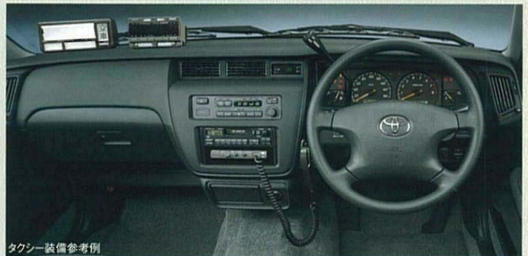
Photo:スーパーデラックス LPGコラムシフト車の計器盤。内装色はダークグレー。表示灯、無線機、料金メーターは参考例。
