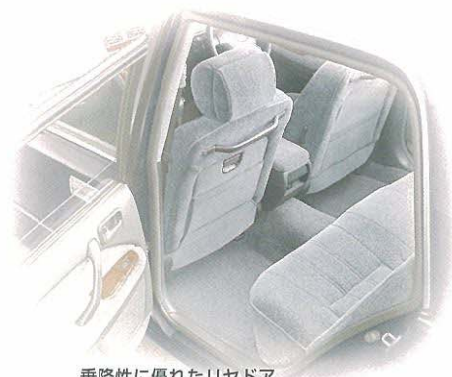
乗降性に優れたリヤドア 高さ(1,058mm)・幅(660mm)ともにゆとりがあり、 大きく開くリヤのドアから、スムーズにご乗車いただけます。
