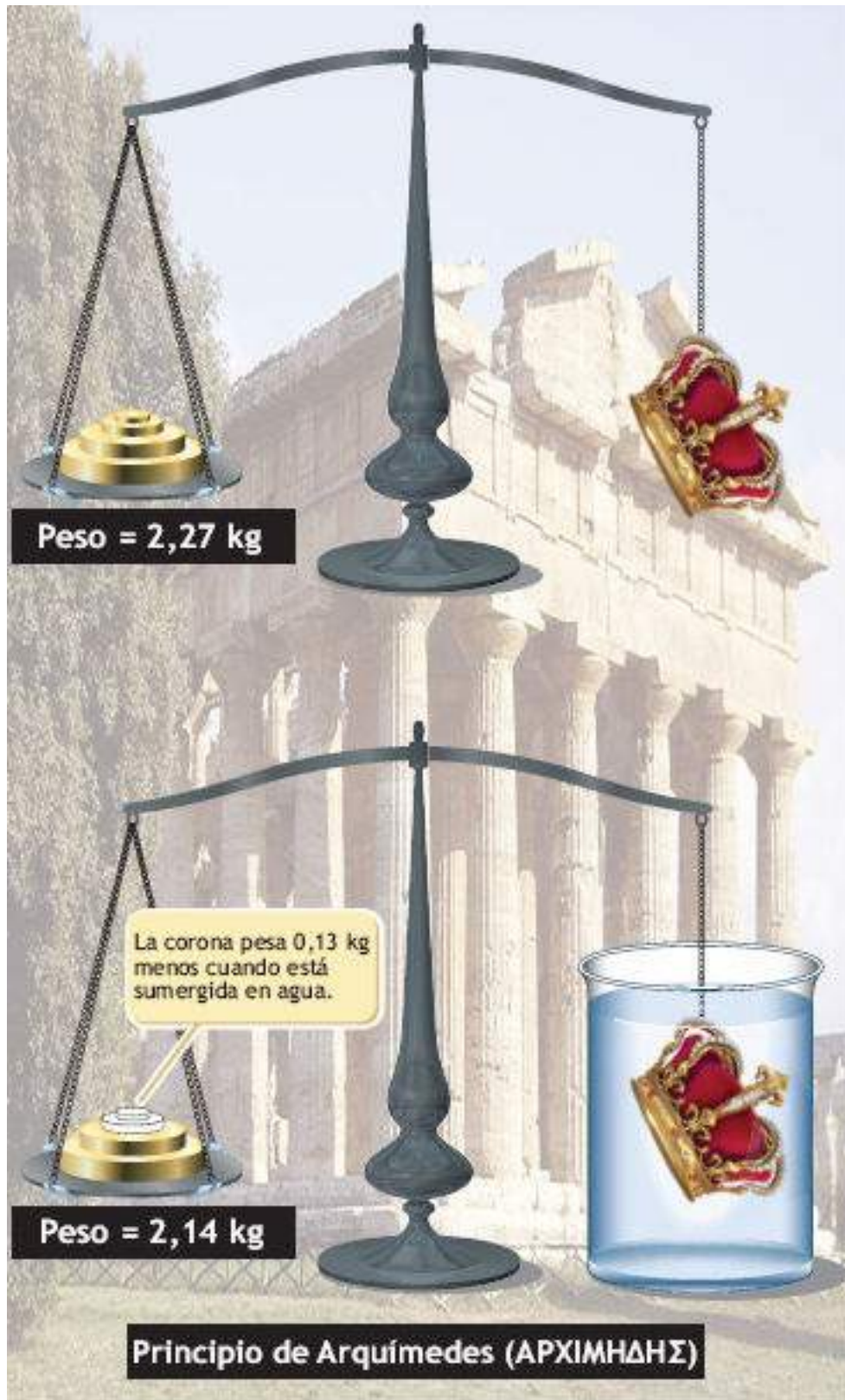
FIGURA 28.7 • Principio de Arquímedes de la fuerza de flotación para determinar el volumen y, después, la densidad relativa de la corona del rey.
