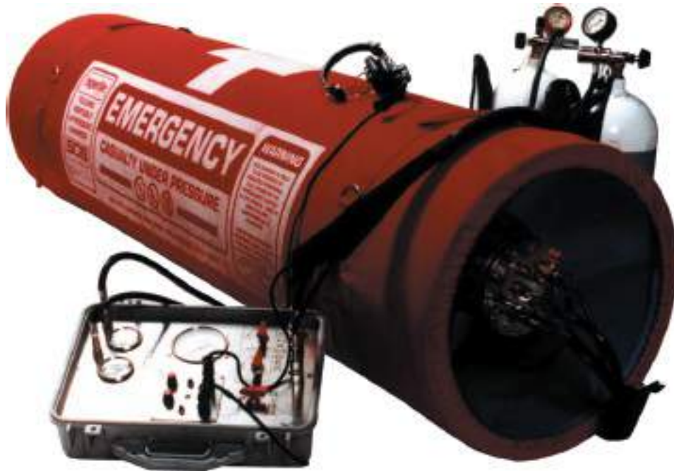
FIGURA 26.9 • Cámara para recompresión portátil (50 kg) y plegable para el buceo en lugares remotos. Un cilindro de aire comprimido genera un diferencial de presión de trabajo de 2,1 ata (bar) o 21,35 m (70 fsw), entre el ambiente de la cámara y el aire ambiental; el buzo recibe oxígeno a través de una mascarilla para ventilación. El tubo se fabrica utilizando una fibra de aramida (como Kevlar) en una matriz de hule de silicón. Esto proporciona flexibilidad (puede plegarse cuando no se utiliza) y una resistencia considerable bajo presión (presión de estallamiento aproximada de 14 ata de presión diferencial; fabricada por SOS Limited , Londres, Inglaterra; fotografía por cortesía de John Selby, de SOS Hyperlite de Douglas, Isla de Man).
