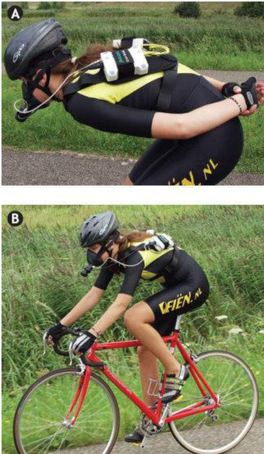
FIGURA 8.4 • Los sistemas portátiles de colección metabólicos emplean la más reciente tecnología computarizada en miniatura. Las células analizadoras del oxígeno y dióxido de carbono incorporado, junto con un medidor de microflujo altamente sensible, miden la carga de oxígeno por el método de circuito abierto durante diferentes actividades, como (A) patinaje en línea y (B) ciclismo. (Adaptado con autorización de McArdle WD, Katch FI, Katch VL. Sports and Exercise Nutrition . 4th Ed. Philadelphia: Wolters Kluwer Health, 2013).
