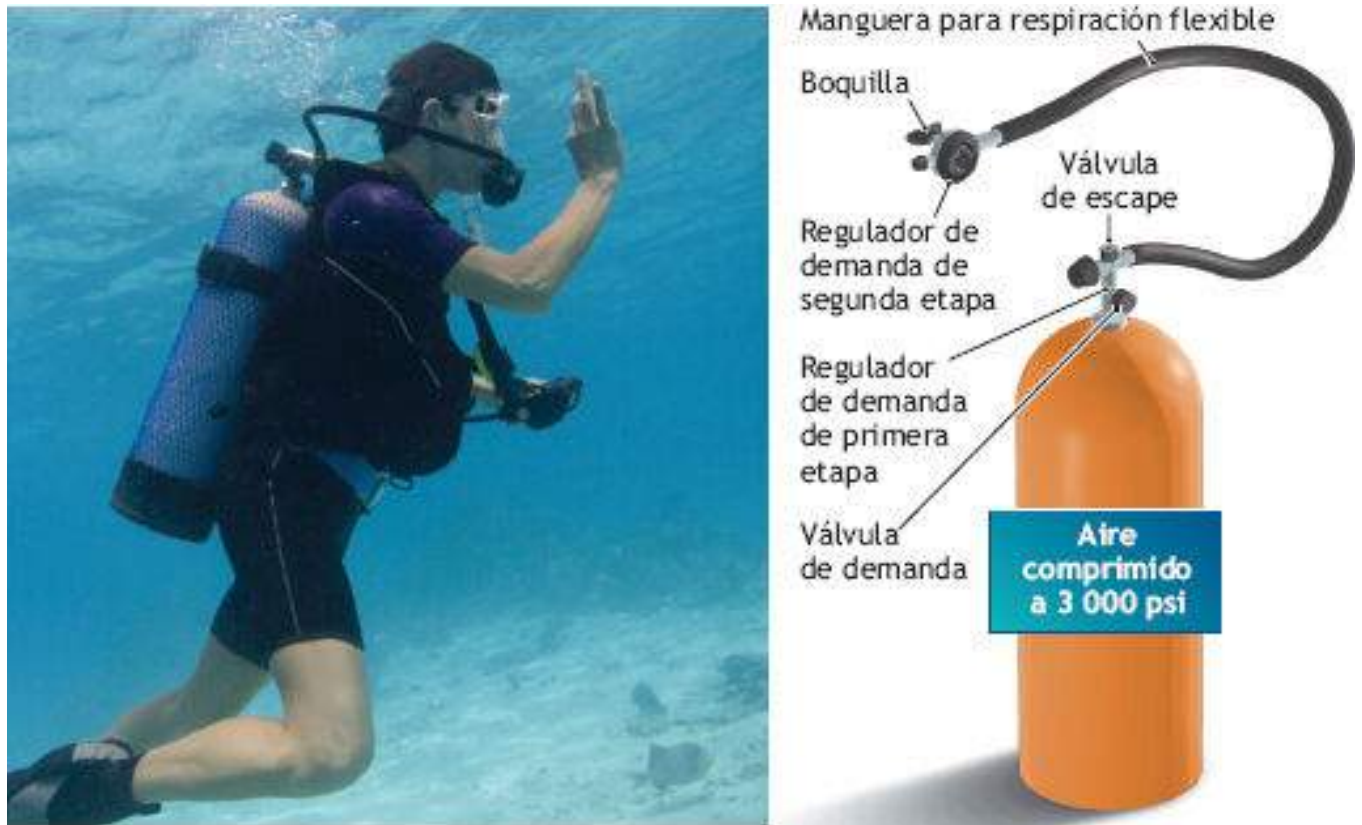
FIGURA 26.3 • Diseño general de una unidad scuba de circuito abierto. El aire comprimido fluye a través de una válvula reguladora de dos etapas que reduce la presión del tanque hasta una presión casi respirable a una profundidad específica y libera el aire para el buzo a demanda, con una presión idéntica a la «ambiental», de tal forma que el buzo respira sin dificultad.
