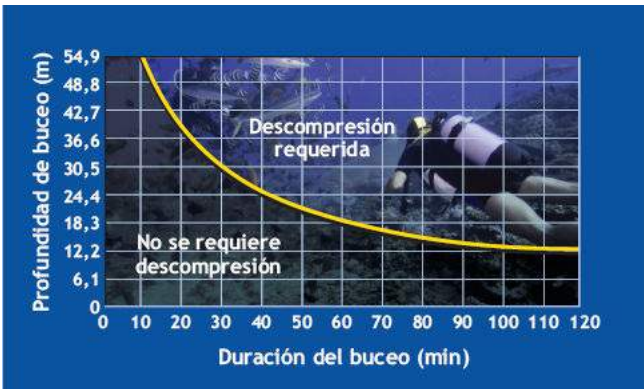
FIGURA 26.8 • Límites para la no descompresión. Cualquier inmersión aislada que caiga a la izquierda de la curva no requiere descompresión, siempre y cuando la velocidad de ascenso no exceda los 18,3 m × min. Las inmersiones que quedan al lado derecho de la línea hacen necesario el período de descompresión que se especifica
