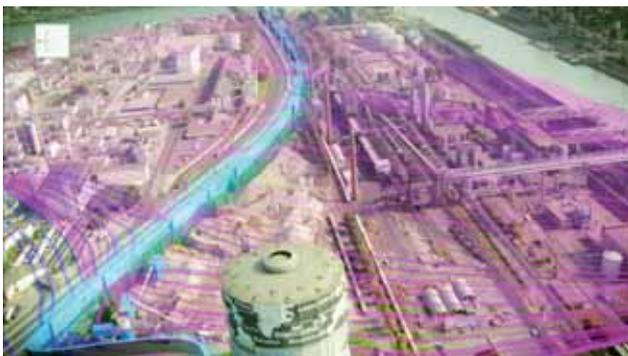
Funnel & Gate-System: rot die Strömungslinien des Grundwassers, blau die Dichtwand mit den Filterelementen.
