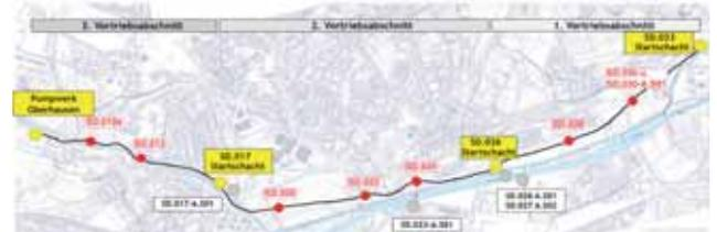
Trassenverlauf des Bauabschnitts 40 mit den drei Vortriebsabschnitten.
