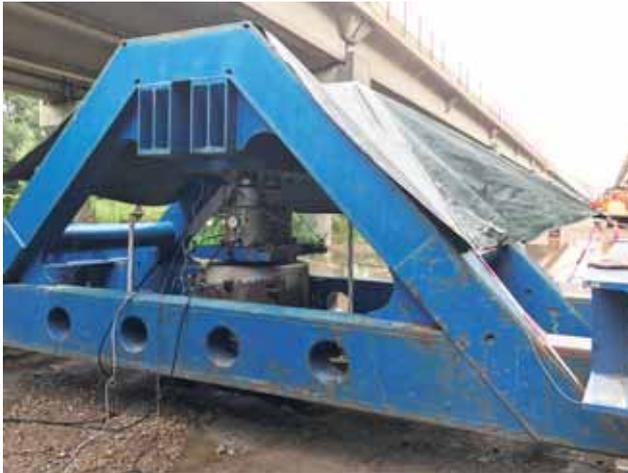
Widerlagerkonstruktion für die statischen Pfahlprobelastungen der Ingenieurservice Grundbau isg.
