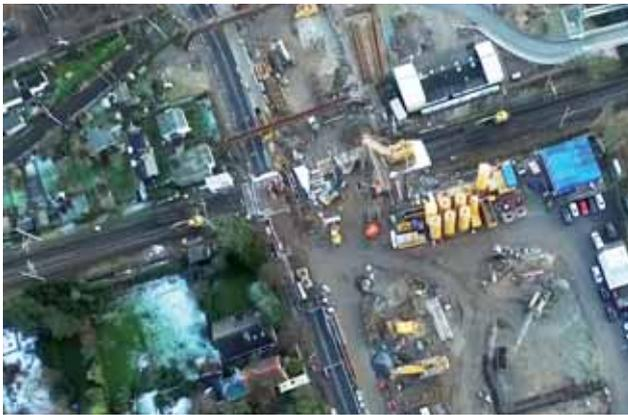
Luftaufnahme der FRANKI Baustelle in Hamburg. Als Straßenunterführung ist ein Trogbauwerk geplant, in das zwei Rahmenbauwerke integriert sind.
