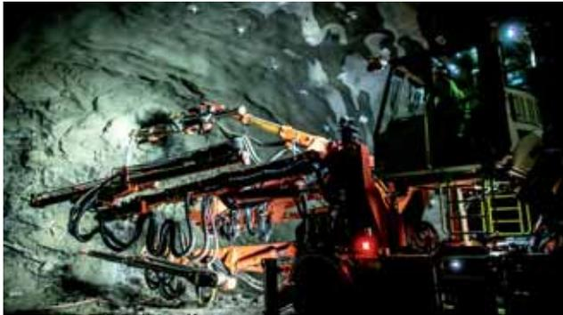
Mit dem dreiarmigen Sandvik-Bohrwagen können die Sprenglöcher auch vollautomatisch hergestellt werden.
