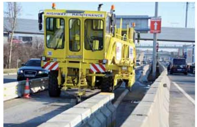
Der „Road Zipper“ nimmt die Betonleitwände vorne auf, verschiebt sie im Inneren und „spuckt“ sie hinten versetzt wieder aus.
