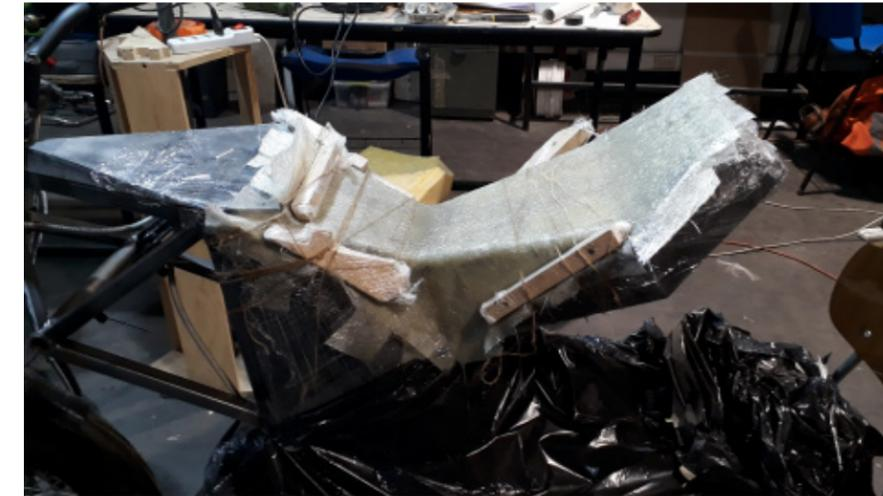
**FIGURA 71.** PIEZAS DE CARENADO IMPRESAS EN 3D Y LAMINADAS EN SU INTERIOR. FUENTE: ELABORACIÓN PROPIA.
