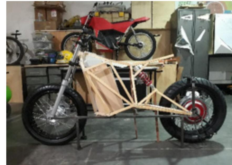
**Etapa I.** La primera iteración de chasis se desarrolla en listones de madera, simulando el perfil metálico proyectado para el final. Sobre este se montan los principales componentes de la motocicleta y/o volúmenes que los simulan. A partir de esta estructura se comienza a iterar el primer carenado en papel, que siguió las principales líneas y superficies planas que ofrece el chasis.
