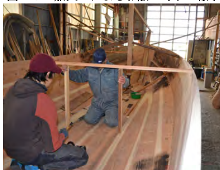
図13 船大工による和船づくりの様子
