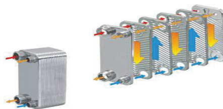
Figura 4-26: Esquema de un intercambiador de placas planas.
