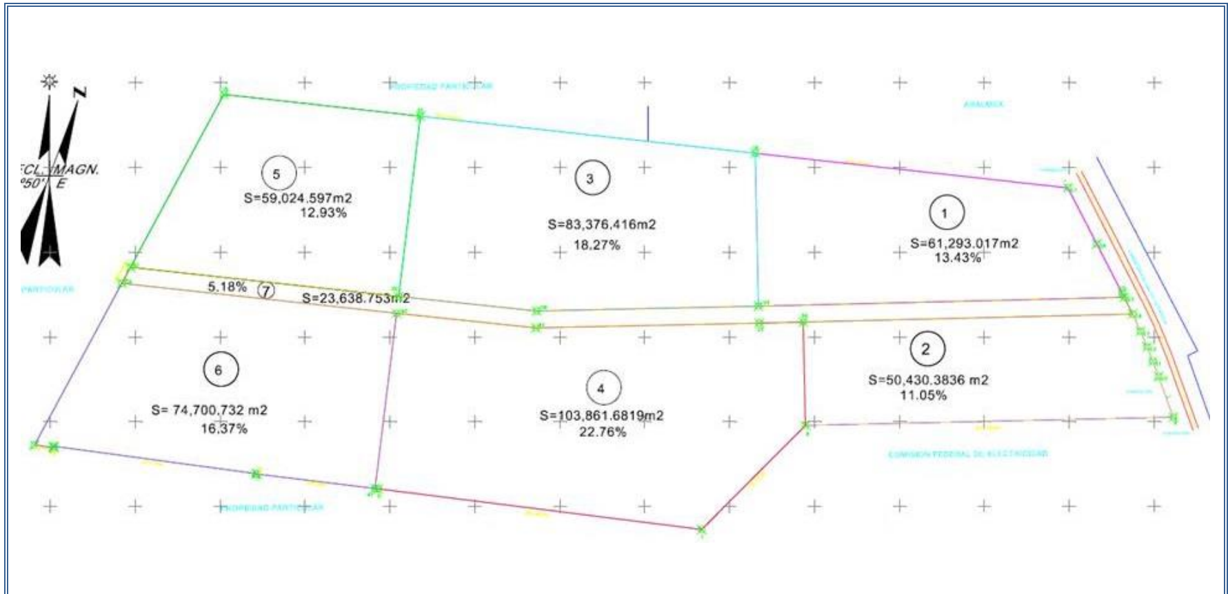
Figura 4. Imagen del plano topográfico que muestra cada una de las secciones en las que fue dividido el predio.
