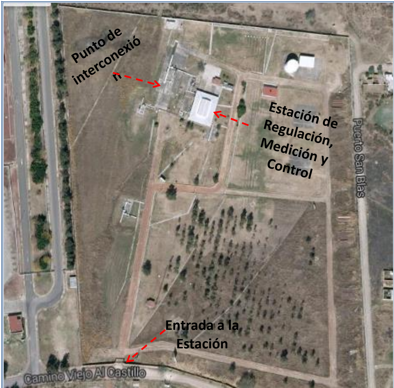
Figura 8. Ubicación del punto de interconexión.
