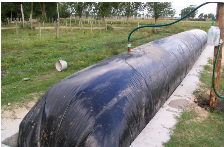
Figura 56: Biodigestor de estructura flexible con protección contra rayos UV.
