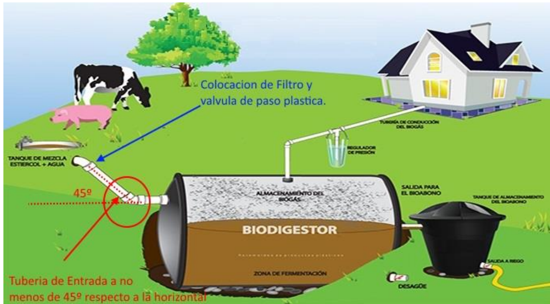
Figura 60: Detalle de la colocación del tubo de abasto proveniente del tanque de mezcla.
