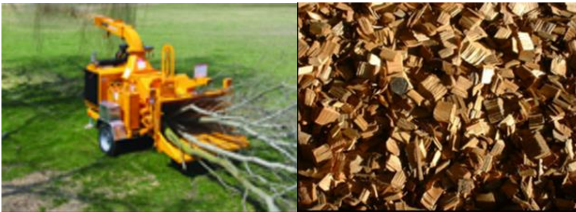
Figura 112. Máquina quebradora de madera (chipeadoras) y chips de madera
