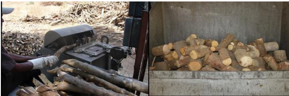
Figura 113. Maquina corta cilindros de madera y cilindros de madera.
