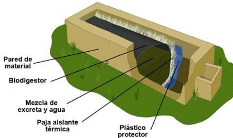
Figura 59: Detalle de montaje de biodigestor en la zanja de retención.
