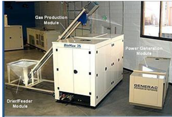
Figura 108: Sistema de gasificación BIOMAX 25.
