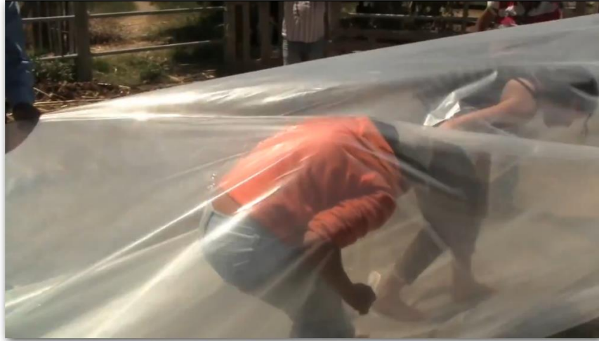
Figura 64: Introducción de la primera capa en la segunda capa para crear la doble bolsa.
