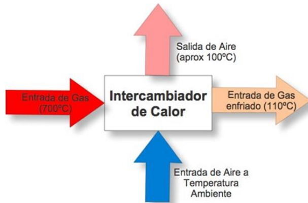
Figura 97: Esquema del enfriamiento. Fuente: Community Power Corporation.
