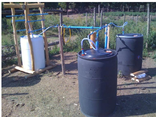
Figura 48: Gasómetro artesanal utilizando barriles.
