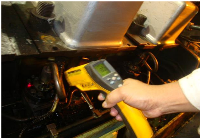
Imagen No 27. Toma de temperatura y viscosidad de forma manual
