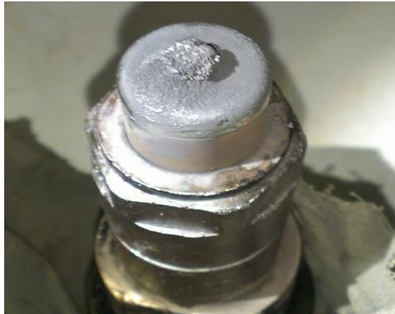
Imagen No 28. Obstrucción de toberas debido a la mala combustión por la alta viscosidad del fue oil
