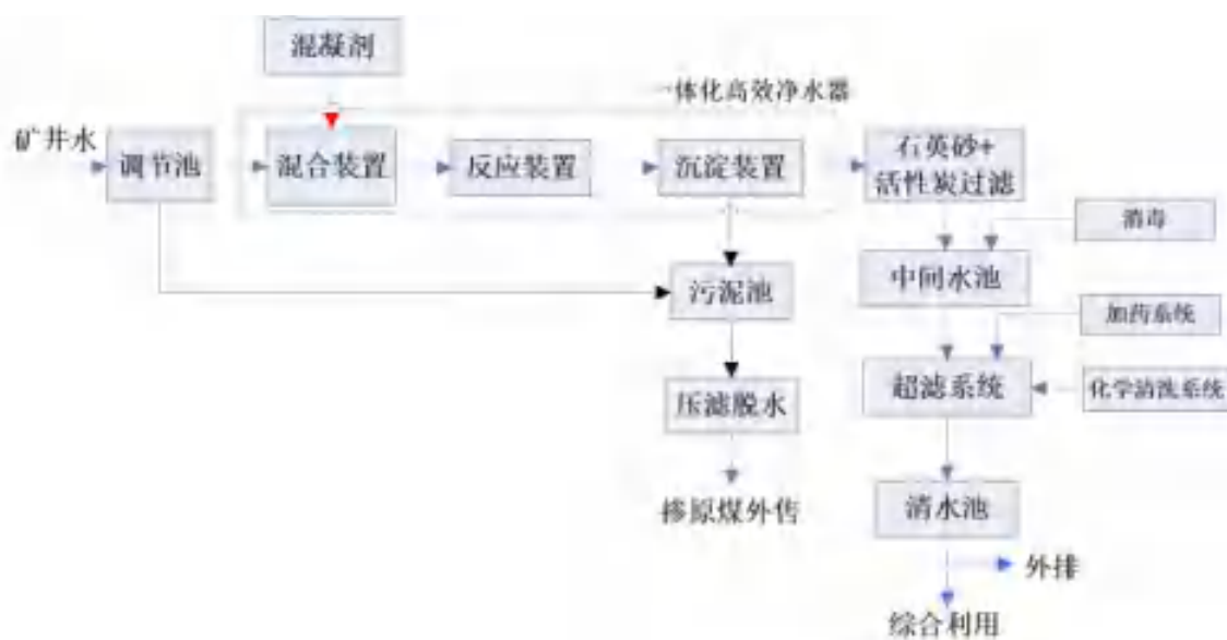
图 7.3-3 生活区矿井水工艺流程图
