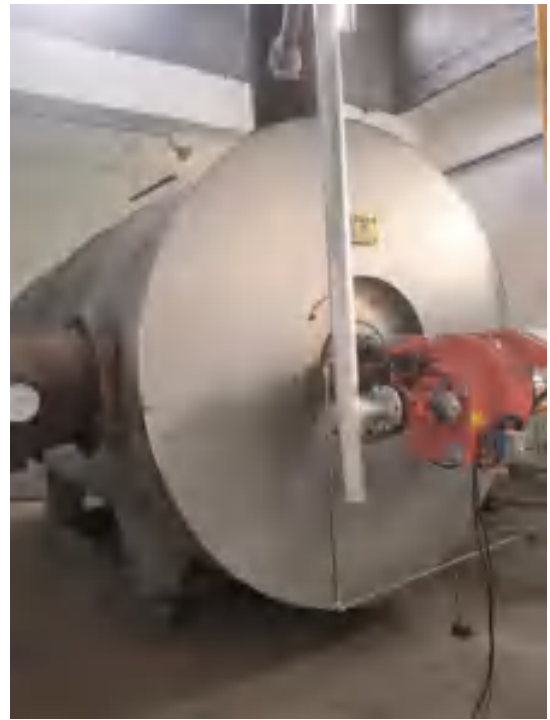
1.4MW 燃气热风炉
