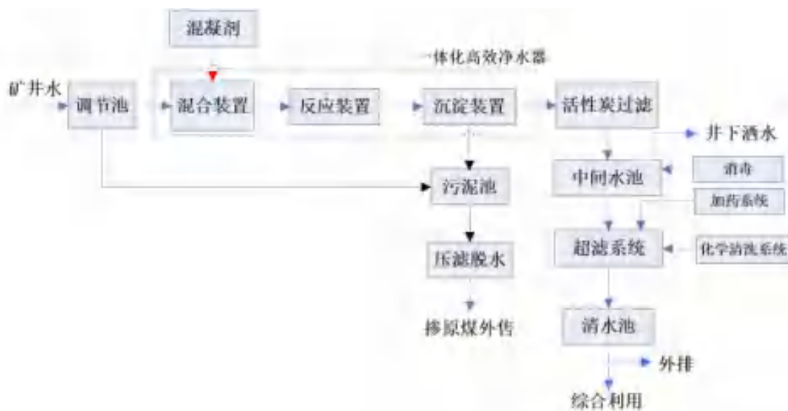
图 7.3-2 生产区矿井水工艺流程图
