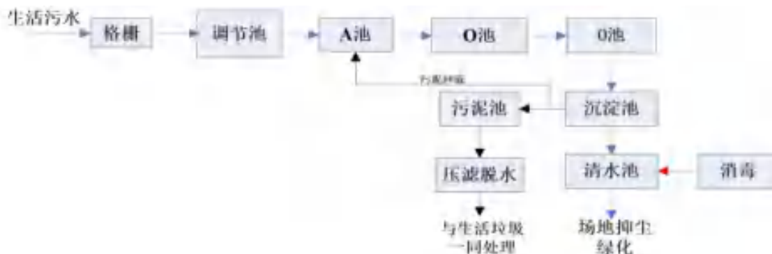
图 7.3-4 生产区生活污水处理工艺示意图
