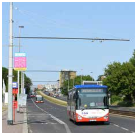
Autobus Iveco Crossway LINE 12LE ev. č. 1252 dopravce POHL Kladno projíždí v květnu 2023 po ulici Evropské pod připraveným výložníkem se závěsy pro budoucí trolejbusovou trať linky č. 59. Foto: Libor Hinčica
