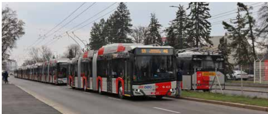
Odstavené trolejbusy Škoda-Solaris 24m na ulici K Letišti, odkud postupně vyjžděly dne 6. 3. 2024 na linku číslo 59. K nabíjení využívaly stopu posilovacího vedení, které není v běžném provozu určeno pro pojiždění. Foto: Vojtěch Povolný
