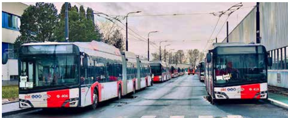
Odstavené trolejbusy Škoda-Solaris 24m v areálu garáží Řepy. V jižní části garáží je použita párová soustava sloupů pro dvojici stop. Foto: DPP
