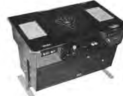
スペースフューリ 宇宙戦争がテーマで、カラーベクトルシステムによる同社初のカラーXYモニター採用。母船とのドッキングで発射方向は3種。定価68万円。【セガ社】No172
