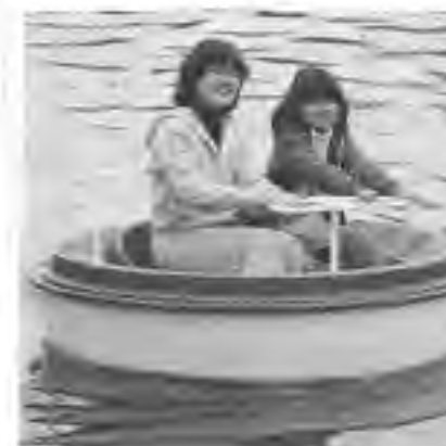
UFOボート 池の上に浮かべるボートで、動力を一切使用せずハンドル操作だけで前後進させるもの。船体はFRP製で円形。2人用。定価25万円。【コトフキ】No173
