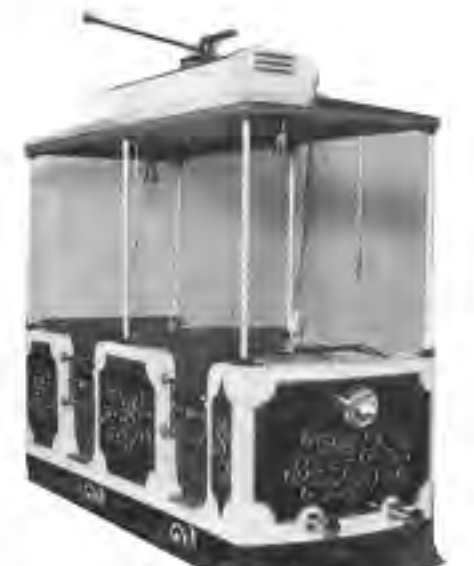
サイクル電車 乗客が足でペダルをこいで走行する電車で、電気は使用しない。ヒモを引くとカネの音が出る。前後にブレーキがある。定価2千300万円。【泉興業】No173
