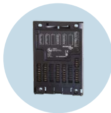
BasicController Hブリッジ回路搭載、 入出力16点付コントローラ
