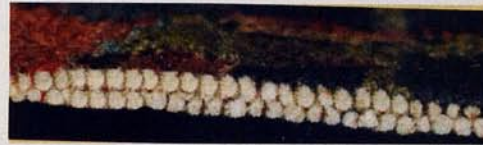
Şəkil 45. Sıx toxumuşlu xalçanın en kəsiyi
