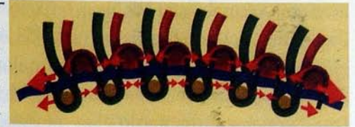
Şəkil 53B. Türk ilmələri ilə toxunulmuş xalçanın əyildikdən sonra əmələ gəlmiş ormasının en kəsiyi
