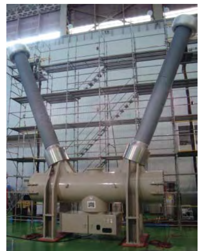
800kVガス遮断器
