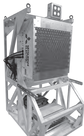
送電部 (アクティブフェーズドアレー)
