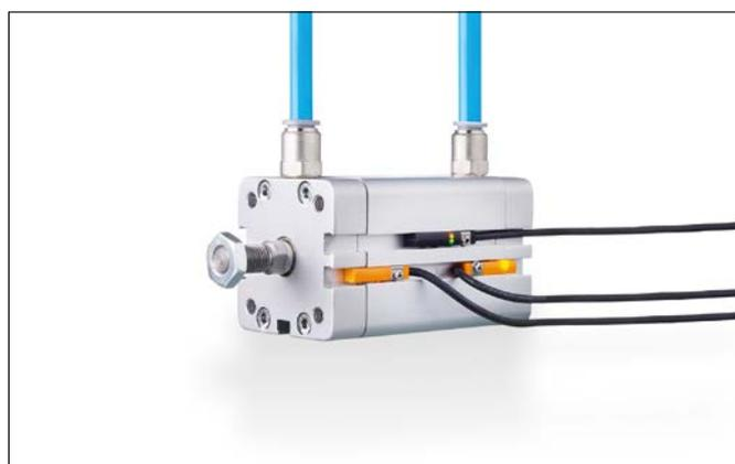
**一体两用：**对于短行程气缸而言，现在使用1个IO-Link气缸传感器（上槽）就足以检测两个末端位置，而无需像过去一样使用2个常规传感器（下槽）。
