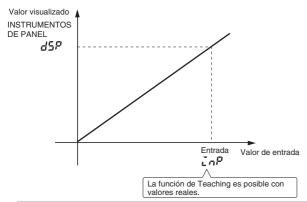
En vez de realizar ajustes mediante las teclas (a) UP y (b) SHIFT, es posible introducir valores reales como valores de entrada de escala para el Teaching. Este procedimiento es útil para realizar ajustes mientras se comprueba el estado de operación del K3MA-F.
