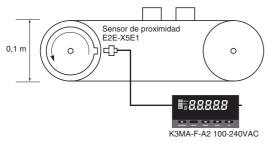
Aquí, la velocidad de alimentación de la cinta transportadora se visualizará en unidades de 0,1 m/min.
