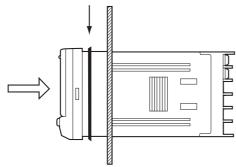
Ajuste el adaptador en las hendiduras en los lados izquierdo y derecho de la carcasa posterior, y luego empújelo hasta que haga contacto con el panel para asegurar así el K3MA-F.
