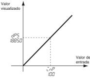
Cuando se visualiza el caudal (por ejemplo, durante 1/min o 1/h), es preciso ajustar los valores de escala después de confirmar las características de E/S del sensor de caudal. Algunos sensores de caudal envían señales analógicas. Si utiliza este tipo de sensor de caudal, es recomendable usar el K3MA-J.
