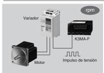
Nota: Si la salida de monitorización del inversor es analógica, por ejemplo 0 a 10 V, utilice el K3MA-J.
