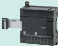
CP1W-MAD42 Ingangen: 4 (resolutie: 12.000) Uitgangen: 2 (resolutie: 12.000)
