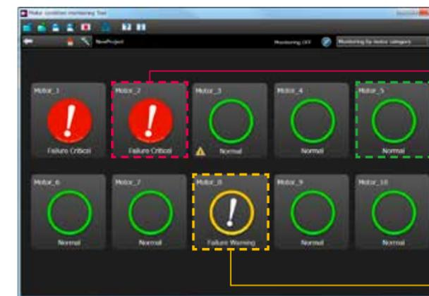
A través de la serie K6CM conectada a la red se muestran los estados de hasta 10 motores como una lista. Se pueden visualizar los datos de hasta 30 unidades K6CM. (Se pueden instalar tres tipos de K6CM en un motor)
