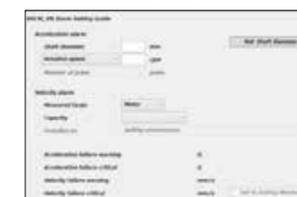
Introduzca el diámetro del eje, la velocidad de rotación y la capacidad, y podrá ajustar automáticamente el umbral del modelo K6CM-VB.
