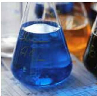
染料は着色したり、ある波長の光を遮光したりするのに用います。染料は有機溶剤や水に溶けるので、塗料を作るのは簡単ですが、できあがった製品の耐候性は一般的には顔料に比べ劣ります。
