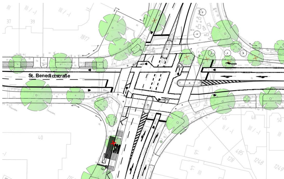
Abbildung 1: Variante 1 - lichtsignalgesteuerter Knoten
